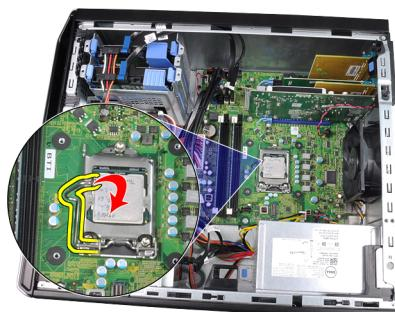
8. 從插槽中將處理器向上拔起，並將其放置在防止靜電的包裝中。
