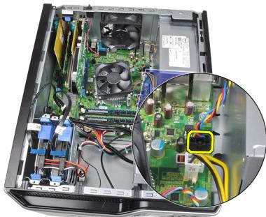
4. 撬開 4 個將系統風扇固定至電腦背面的扣眼，並將系統風扇卸下。
