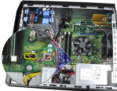
4. 使用十字槽螺絲起子將用來固定散熱器/風扇至主機板的緊固螺絲鬆開。
