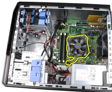
6. 漲下釋放拉桿然後向外移動，將釋放拉桿從固定它的固定掛鉤中釋放。
