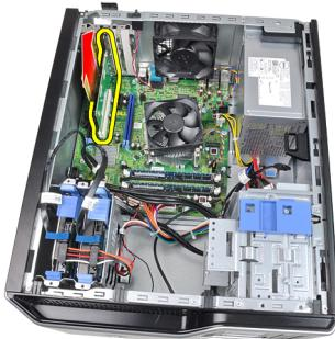
7. 從連接器中取出 PCI x4 擴充卡 (如有)，並將插卡從系統卸下。
