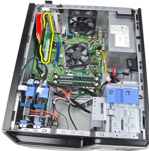
6. 從連接器中取出 PCI 擴充卡 (如有)，並將插卡從系統卸下。
