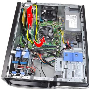
5. 從連接器中取出 PCIe x1 擴充卡 (如有)，並將插卡從系統卸下。
